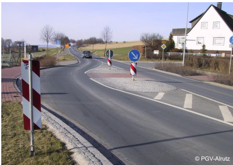
Abb. 4-26: Mittelinsel im Zuge einer Radverkehrsverbindung
