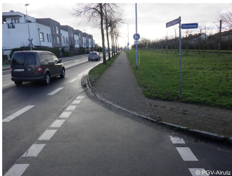
Abb. 4-10: Gehweg mit zugelassenem Radverkehr (Beispiel Magdeburg)
