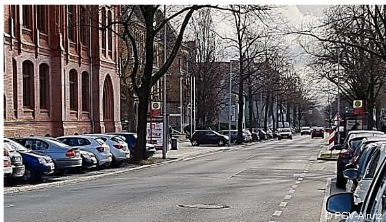
Abb. 4-3: Mischverkehr mit markiertem Sicherheitsraum zum Parkstreifen
