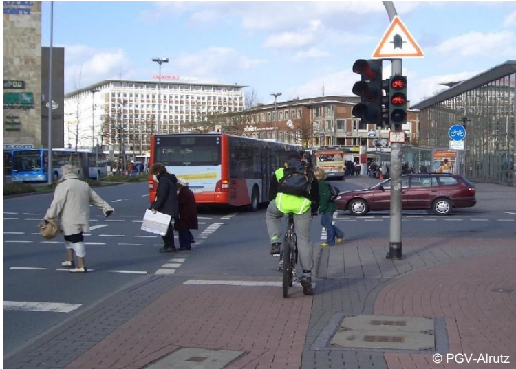
Abb. 4-22: Radverkehrssignal mit Vorlaufgrün für den Radverkehr
